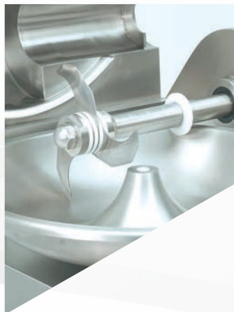
Abnehmbarer Messerkopf mit 3 Qualitätsmessern, optional mit 6 Messern
