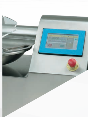
7-Touchscreen mit digitaler Anzeige von Messerdrehzahl, Temperatur, Uhrzeit, Restlaufzeit. Variable Messergeschwindigkeit 750 – 3000 U./min. + 4 Schnellwahltasten
