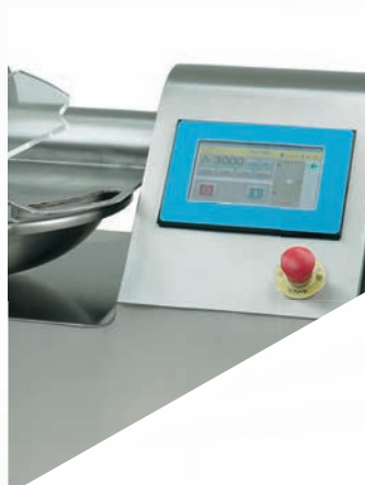
Программируемый 7-дюймовый сенсорный экран с цифровой индикацией скорости вращения ножей, температуры, времени суток, обратного отсчета времени. Различная скорость ножей: 750-3000 об/мин + 4 кнопки выбора скорости
