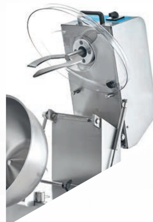
Откидная верхняя часть машины с пневматической пружиной
