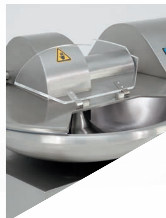
Прозрачная звукоизолирующая крышка для контроля
