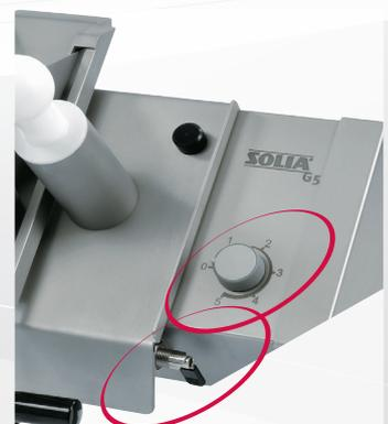
Stufenlose Geschwindigkeitsregelung von 130 - 360 Umdrehungen
