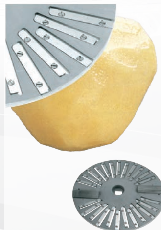
Schältscheibe mit aufgesetzten Messern Glatte Oberfläche – wie handgeschält. Erhöhter Schälabfall, geringste Rötung, kürzere Schälzeit.
