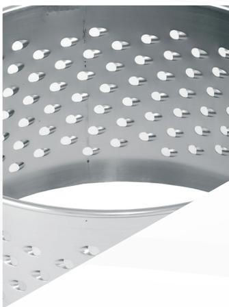
Die Geometrie der zahlreichen, nach innen geformten Schneiden des Schnitzelzylinders bestimmt die Geometrie des Endproduktes
