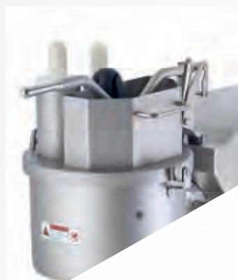
Schneidaufsatz mit doppelter Sicherheitsabschaltung
