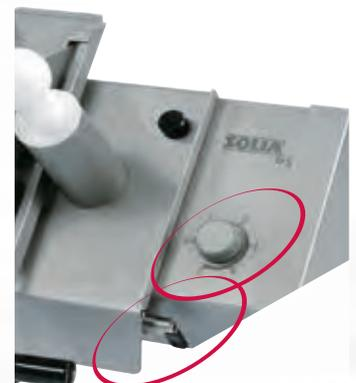
Stufenlose Geschwindigkeitsregelung von 130 - 360 Umdrehungen
