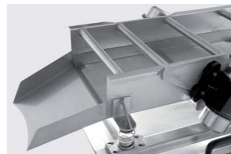
Vibrations-Einrichtung und Ablauf des Produktes Vibration device and product outflow
